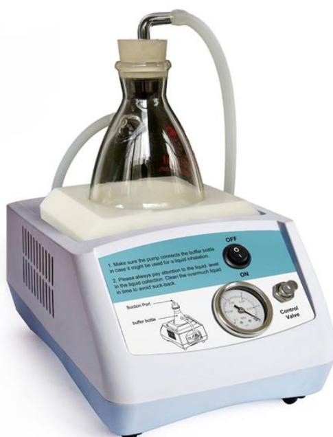
VP-26 真空幫浦是提高過濾效率，加強除氣效果的重要過濾設備。為保障過濾介質不被污染，一般均使用無油隔膜式真空幫浦，此類幫浦是通過橡膠膜的往返運動形成真空，專為實驗室各種需要真空設備設計。可用於真空濃縮、真空過濾、真空乾燥等場合。
